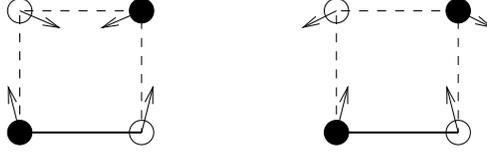
Abbildung 2.3: Veranschaulichung der zwei verschiedenen Chiralitäten des helixartigen Zustandes (s. auch Abb. 2.2). Die linke Abbildung zeigt den Fall positiver Chiralität ( $\Phi > 0$ ) mit  $\varphi_{\hat{x}} = 3\Phi - \pi < 0$ , d.h. der Winkel zwischen den Spins, die mit  $J'$  koppeln ist negativ, der Spin des Untergitters  $A$  wird also mit negativen Drehsinn (mit dem Uhrzeigersinn) gedreht. Rechts wird analog der Fall negativer Chiralität ( $\Phi < 0$ ) dargestellt.
